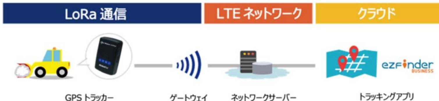
IoT向け通信技術Low Power Wide Area (以下 LPWA) ネットワークの一つである「LoRaWAN (TM)」に対応したGPS端末を除雪車に設置し、位置情報を管理します。
